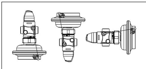
При более высокой температуре среды клапаны следует устанавливать только на горизонтальном трубопроводе регулирующим блоком вниз.
