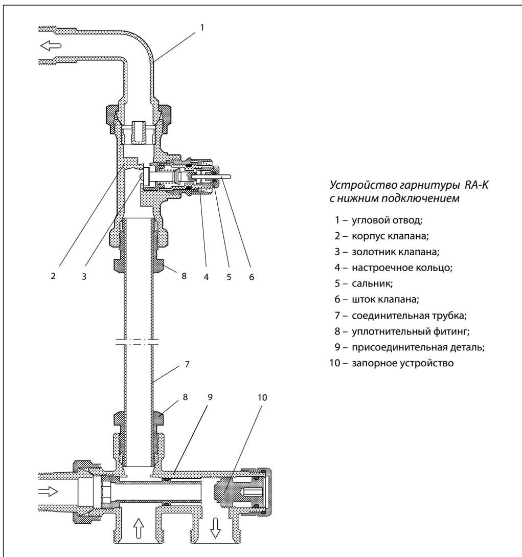
Устройство гарнитуры RA-K с нижним подключением
