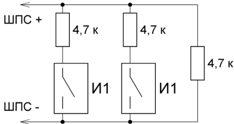
Схема подключения дымовых извещателей ИП 212-90, тип шлейфа 1
