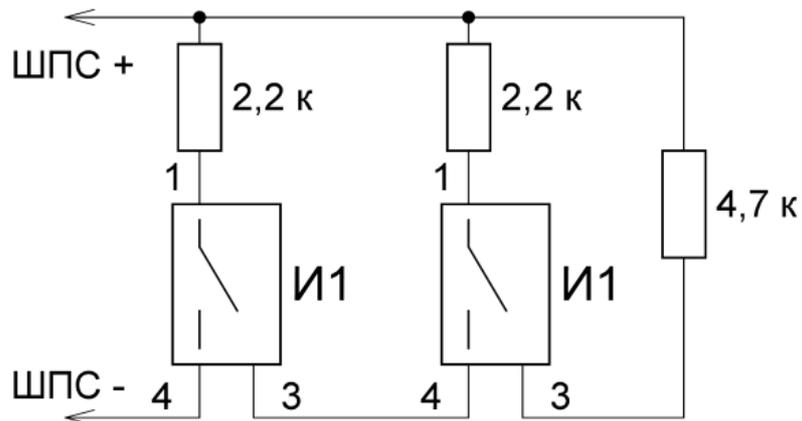
Схема подключения извещателей с выходом «сухой контакт», тип шлейфа 2
