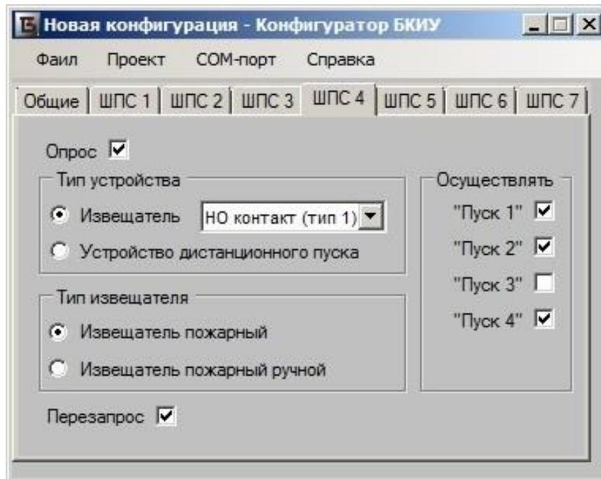
Рисунок 8.15 – Пример конфигурации ШПС
