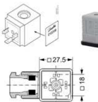
Для предотвращения попадания влаги в клеммную коробку через кабельный ввод кабель должен быть закреплен по всему диаметру и установлен так, как это показано на рисунке. Следует учесть, что надежное уплотнение обеспечивается только для кабелей круглого сечения.
