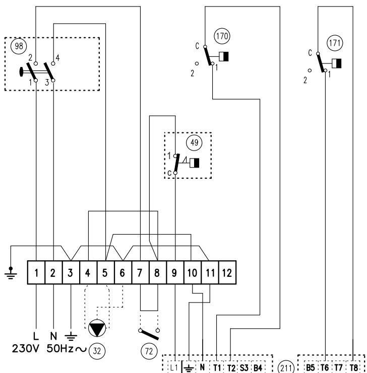
fig. 10 - Elektrisch aansluitschema ATLAS 95
