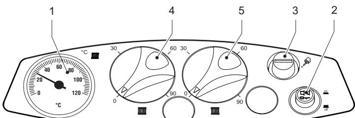
fig. 2 - Panel de control - modelos ATLAS 95
