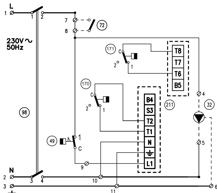
fig. 9 - Esquema eléctrico general ATLAS 95
