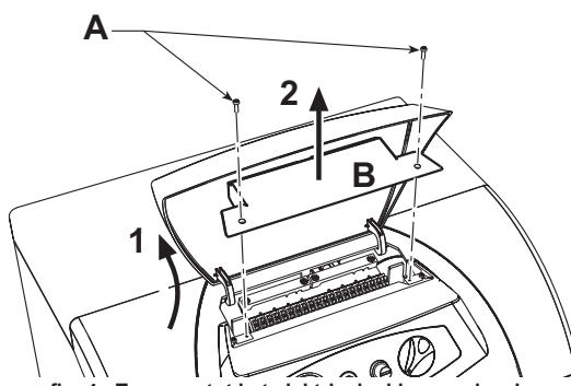
fig. 4 - Toegang tot het elektrische klemmenbord
