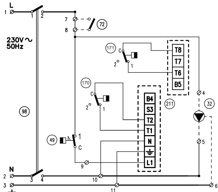
рис. 9 - Принципиальная электрическая схема ATLAS 95
