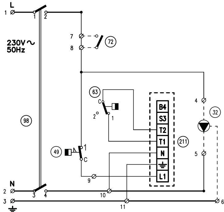
fig. 7 - Schema elettrico di principio ATLAS 32-78
