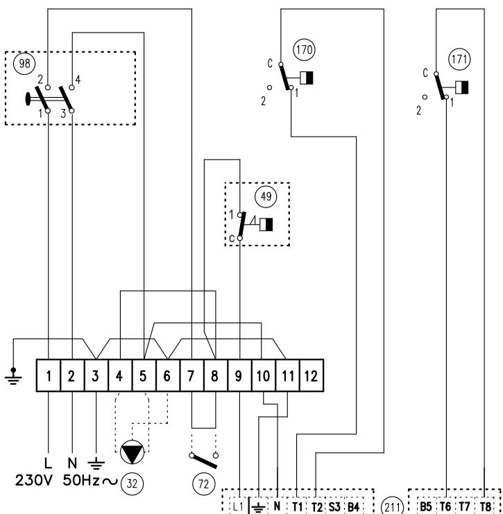
fig. 10 - Schéma électrique de raccordement ATLAS 95
