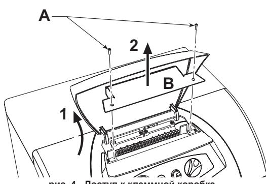
рис. 4 - Доступ к клеммной коробке
