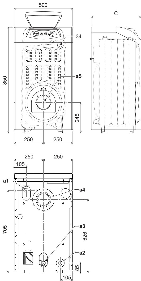
fig. 5 - Dimensions, raccords et composants principaux
