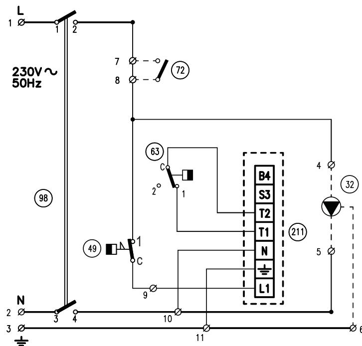
fig. 7 - Esquema eléctrico general ATLAS 32-78
