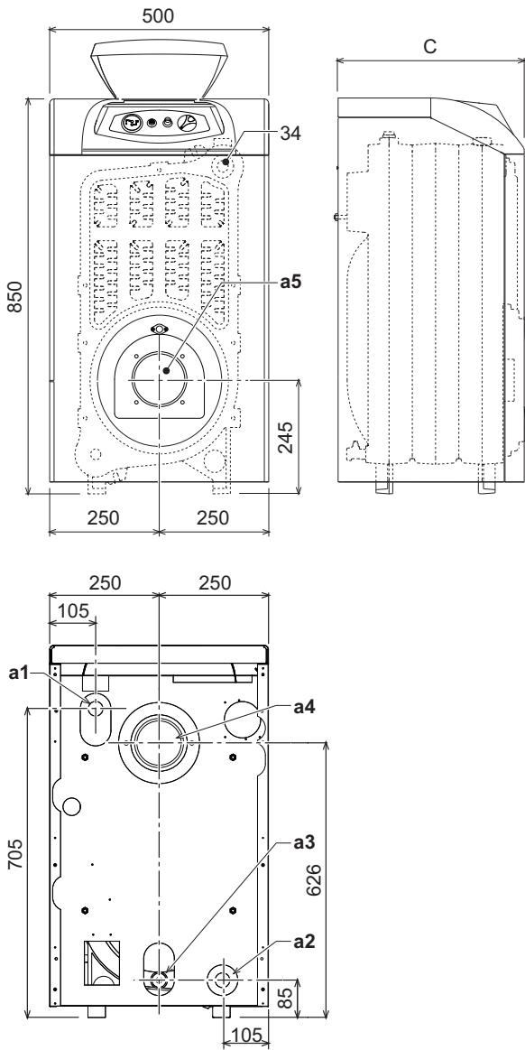
fig. 5 - Dimensionale, attacchi e componenti principali
