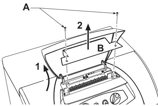
fig. 4 - Acceso a la regleta de conexiones
