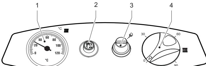
fig. 1 - Pannello di controllo modelli ATLAS 32-78
