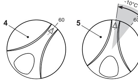
рис. 3 - Регулирование температуры модели ATLAS 95
