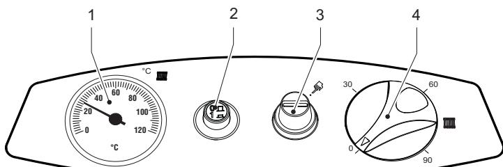
Şekil 1 - Modellerin kontrol paneli ATLAS 32-78
