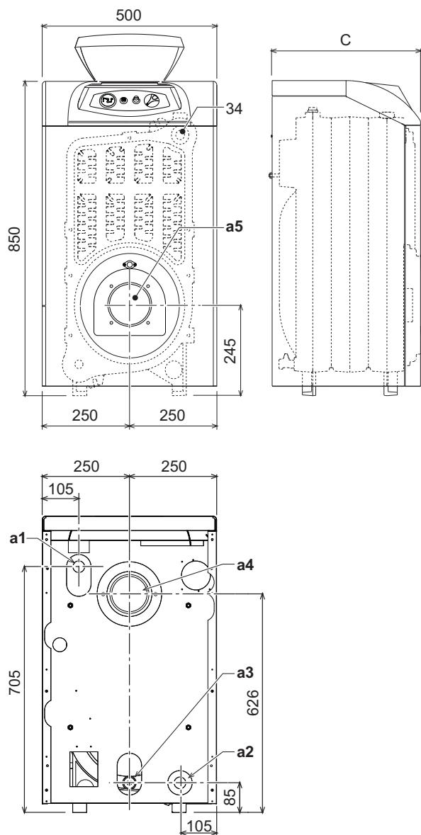
fig. 5 - Dimensiones, conexiones y componentes principales
