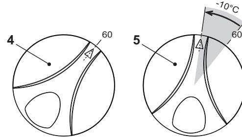
fig. 3 - Regolazione temperatura modello ATLAS 95
