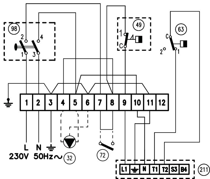
рис. 8 - Схема электрических соединений ATLAS 32-78
