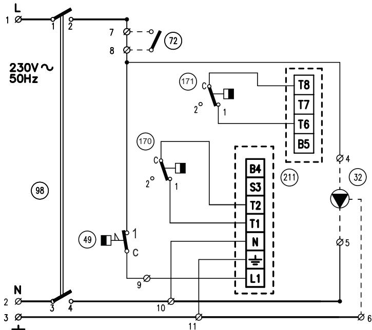
fig. 9 - Schéma électrique de base ATLAS 95
