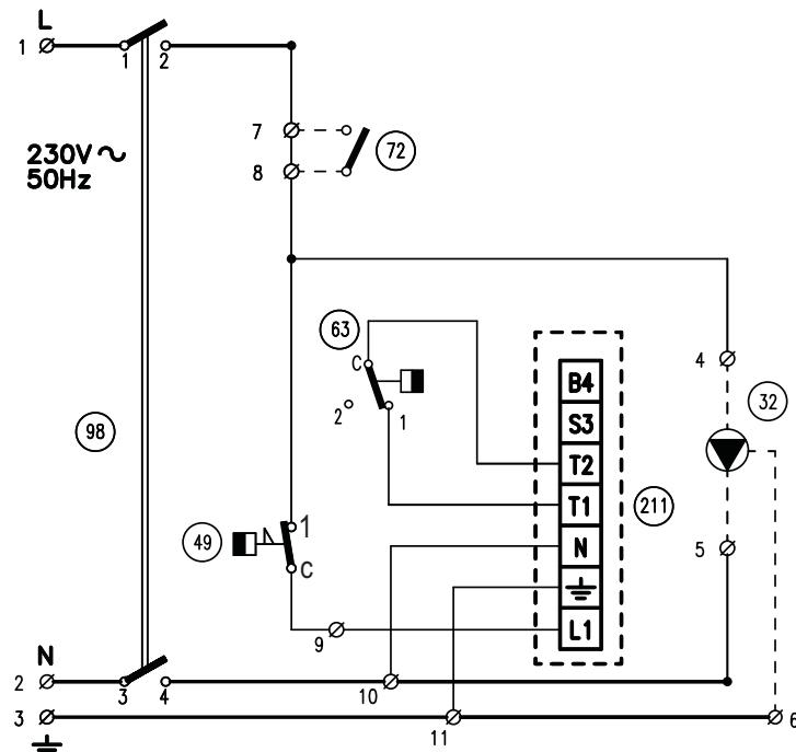
рис. 7 - Принципиальная электрическая схема ATLAS 32-78
