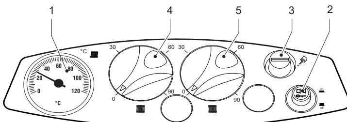
рис. 2 - Панель управления моделей ATLAS 95
