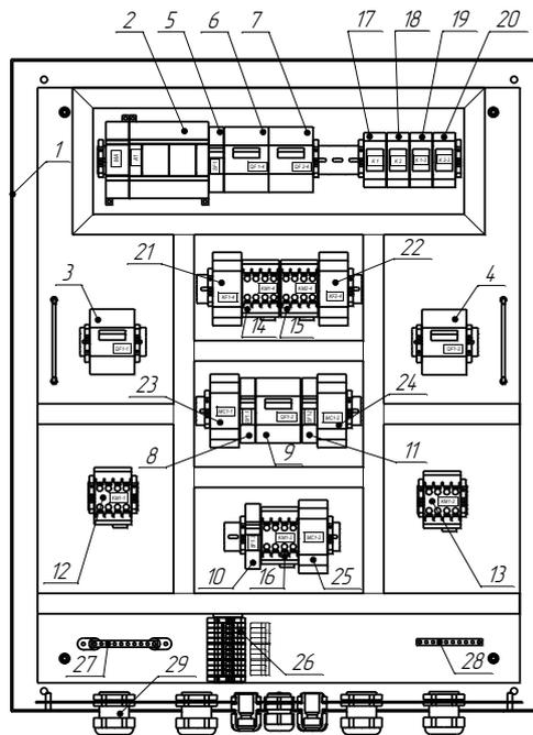
1 – корпус; 2 – программируемое реле; 3, 4 – выключатель автоматический основного и резервного ввода; 5, 6, 7, 8, 9, 10, 11 – выключатель автоматический; 12, 13 – пускатели основного и резервного насоса; 14, 15 – контактор АВР; 16 – пускатель жокей-насоса; 17, 18, 19, 20 – промежуточное реле; 21, 22 – реле контроля наличия фаз; 23, 24, 25 – модуль сопряжения; 26 – клеммная колодка; 27 – шина нулевая; 28 – шина заземления; 29 – кабельный ввод силовых линий.
