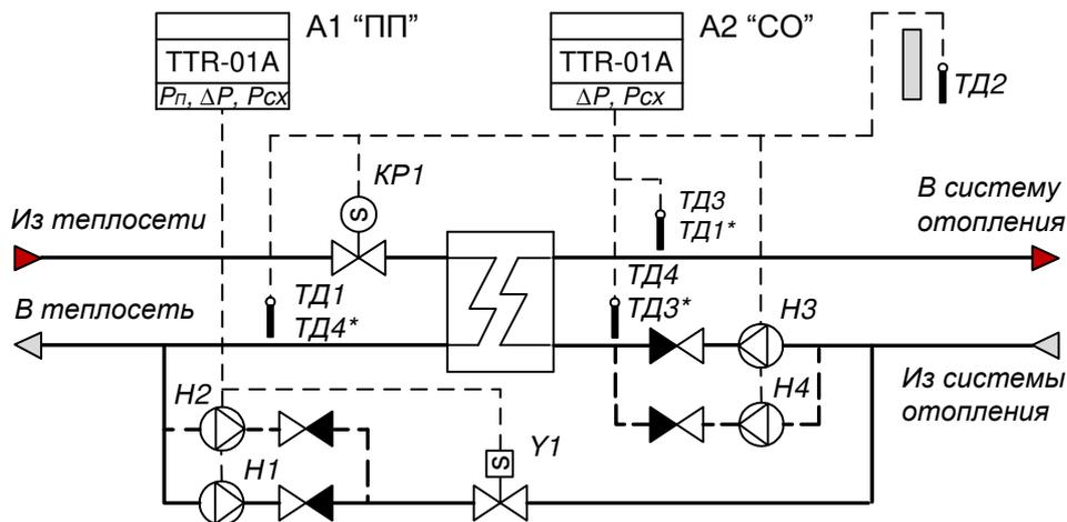
**Пример применения:** ТТР поддерживает в системе отопления температурный график теплоносителя по обратному трубопроводу (\* - по подающему трубопроводу). Давление в контуре отопления поддерживается работой клапана Y1, подпиточного насоса Н1 и, при необходимости, насоса Н2 (резервный).
