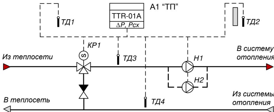
**Пример применения:** TTR поддерживает температуру в помещении согласно временной программе. Для обеспечения циркуляции теплоносителя используется насос Н1 и, при необходимости, насос Н2 (резервный). В зависимости от проекта, насосы могут быть установлены на подающем или обратном трубопроводе системы отопления.
