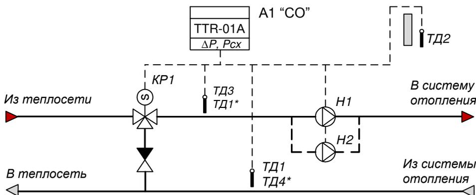
**Пример применения:** TTR поддерживает в системе отопления температурный график теплоносителя по обратному трубопроводу (\* - по подающему трубопроводу) согласно временной программе. Для обеспечения циркуляции теплоносителя используется насос Н1 и, при необходимости, насос Н2 (резервный). В зависимости от проекта, насосы могут быть установлены на подающем или обратном трубопроводе системы отопления.
