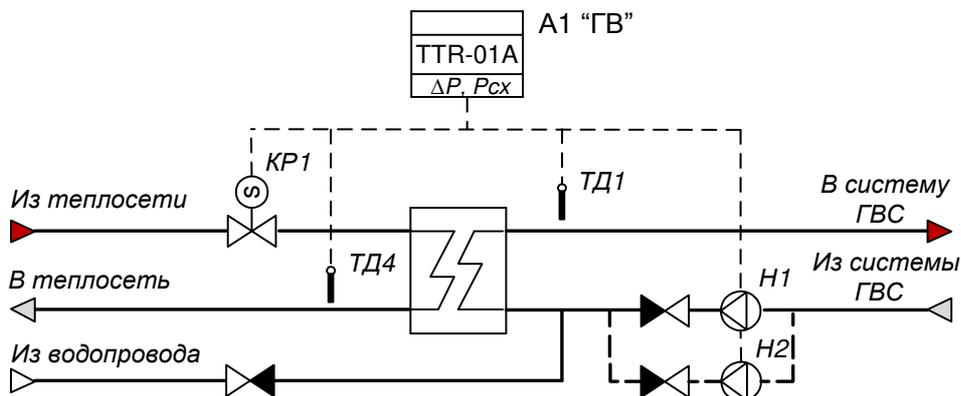
**Пример применения:** ТТР поддерживает температуру горячей воды термодатчиком ТД1 (управляющий) согласно временной программе. Для обеспечения циркуляции теплоносителя используется насос Н1 и, при необходимости, насос Н2 (резервный).
