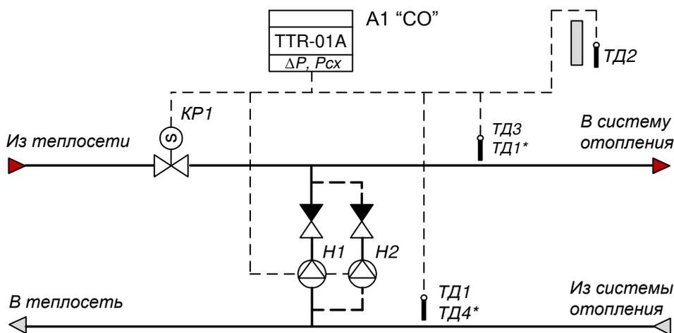
**Пример применения:** ТТР поддерживает в системе отопления температурный график теплоносителя по обратному трубопроводу (\* - по подающему трубопроводу) согласно временной программе. Для обеспечения подмеса теплоносителя используется насос Н1 и, при необходимости, насос Н2 (резервный). В зависимости от проекта, насосы могут быть установлены на подающем или обратном трубопроводе системы отопления.
