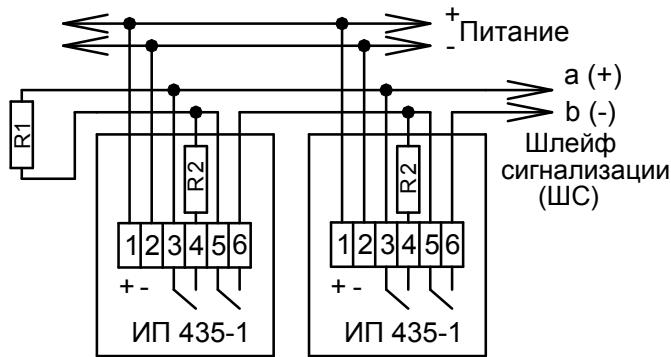
Для ППКОП Сигнал-20ПSmd: R1=4,7кОм, R2=3кОм (изв.Пожар1, Пожар2) или R2=1кОм (изв. Пожар).
