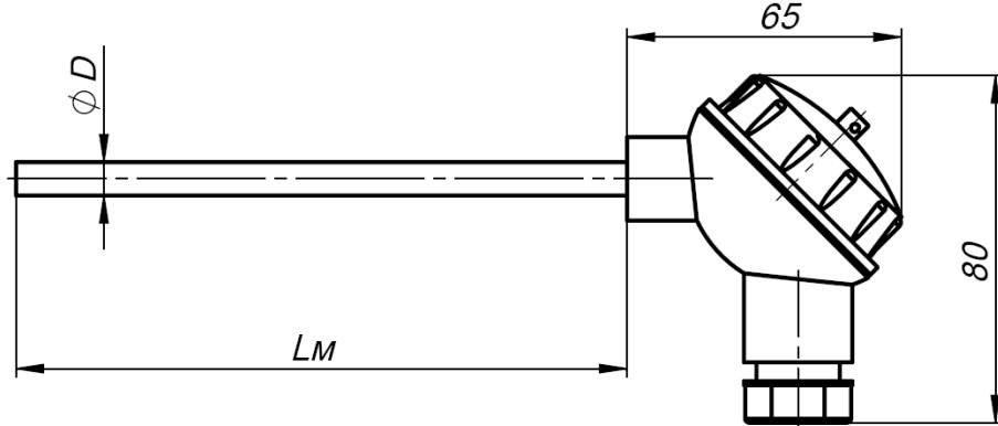
Диаметр монтажной части D, мм: 6; 8
