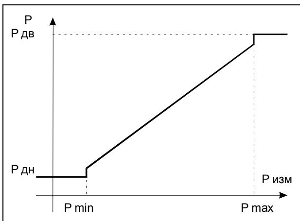
Рисунок К.4 — Обработка измеряемых значений Р
