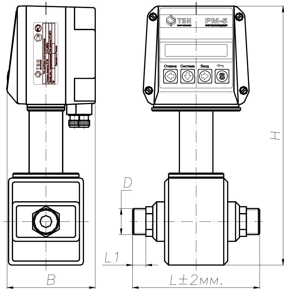
Рисунок В.2 —Резьбовое присоединение датчика расхода
