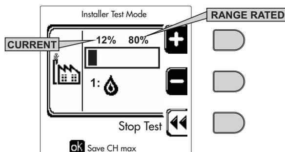
рис. 58 - Тестовый режим TEST (пример: мощность отопления = 80%)
