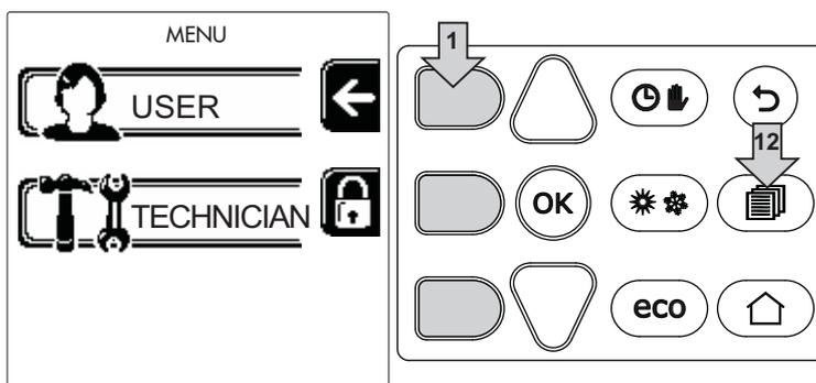
Войдите в меню "USER" путем нажатия на контекстную клавишу 1 (поз. 1 - рис. 1). Затем с помощью клавиш "навигации в меню" можно войти на различные уровни, описанные в следующей таблице.
