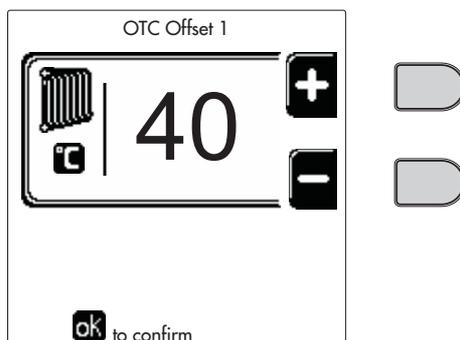
рис. 27 - Параллельное перемещение кривых
