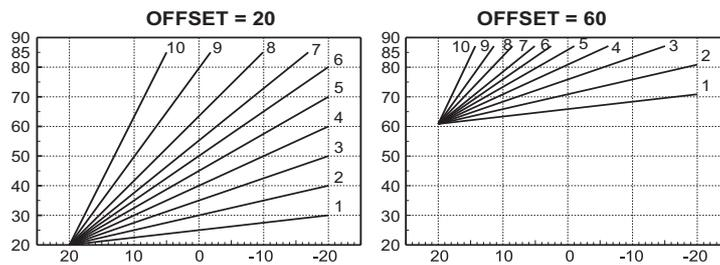
рис. 29 - Пример параллельного перемещения кривых погодозависимого регулирования
