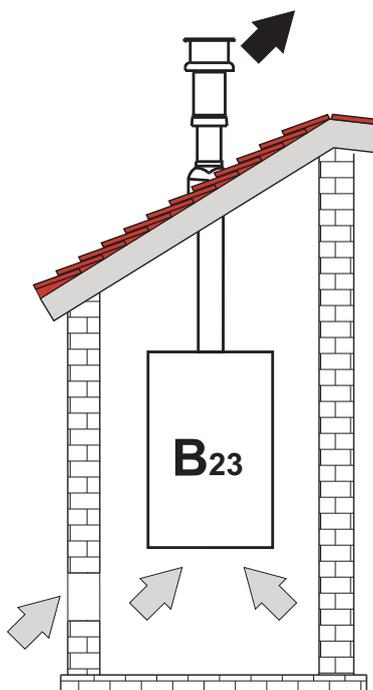
рис. 53- Примеры подключения (⇨ = Воздух/ ⇨ = Дымовые газы)
