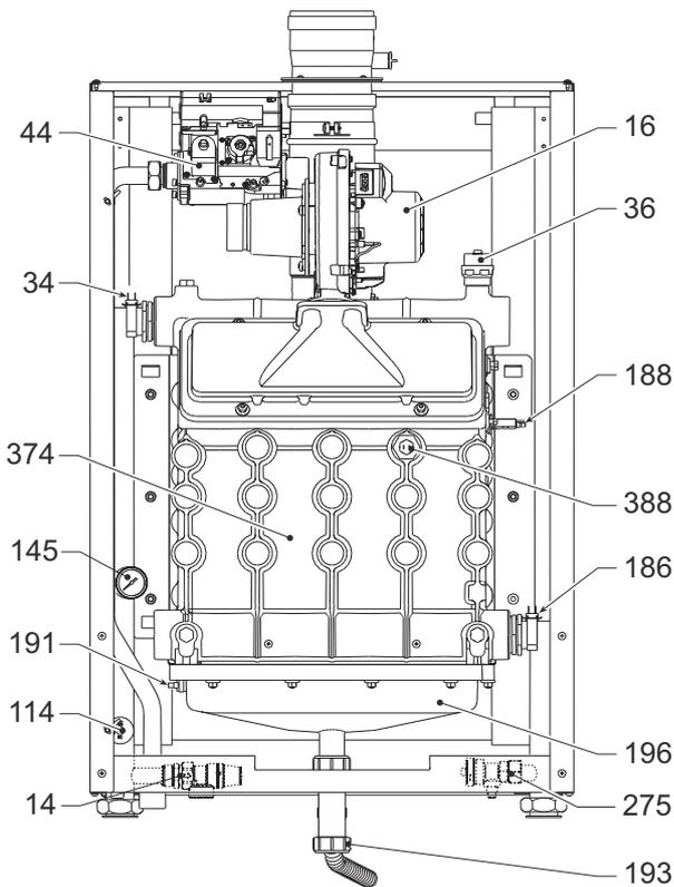
рис. 69- Общий вид, мод. FORCE W 150
