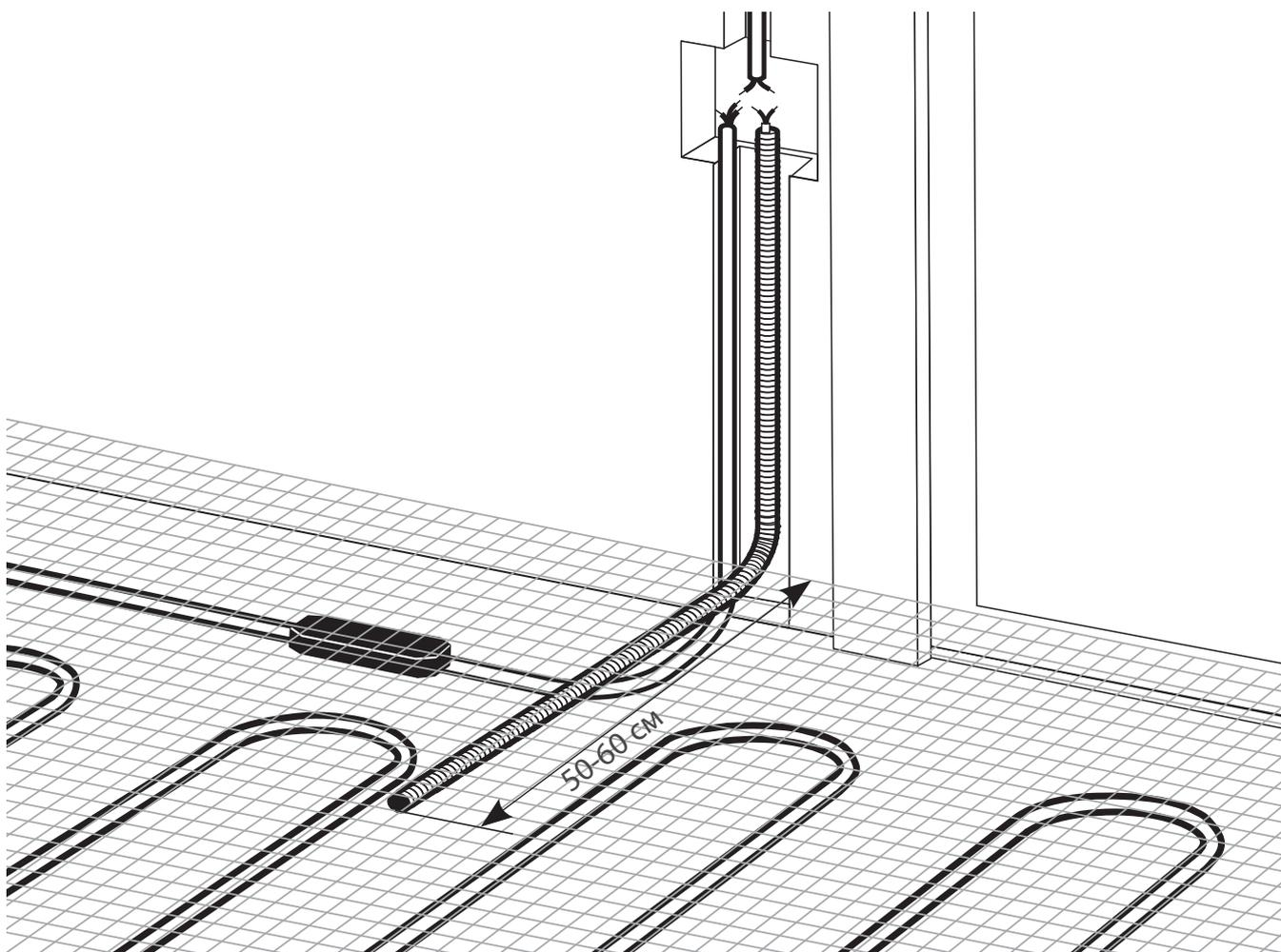
Рис. 2. Схема монтажа датчика температуры
