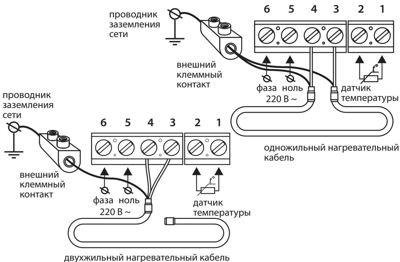
Рис. 5. Схема подключения терморегулятора к 3-хпроводной эл. сети
