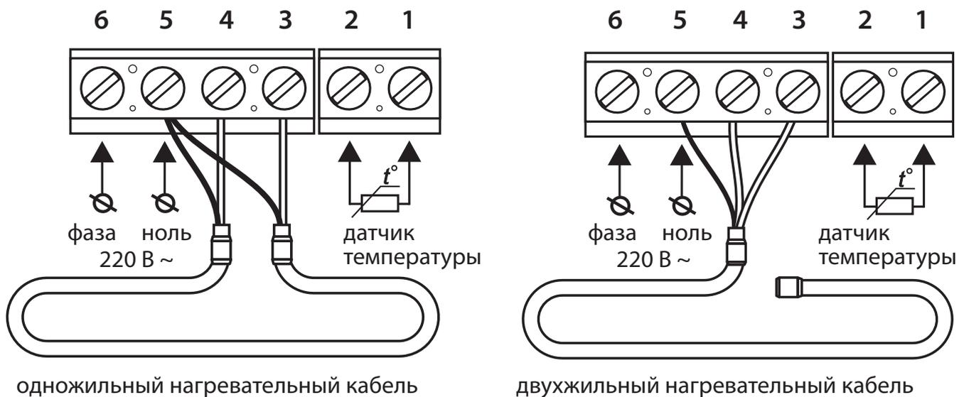
Рис. 4. Схема подключения терморегулятора к 2-хпроводной эл. сети
