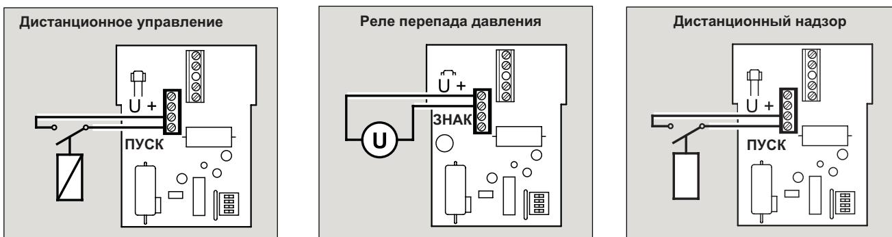
Приводом Z 74 A можно управлять дистанционно при помощи реле с перекидными "сухими" контактами (например, реле Honeywell Centra Bürkle типа REL 2). Минимальное время удержания контактов реле для активизации обратной промывки составляет одну секунду.
