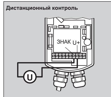
Приводом Z 11 AS можно управлять дистанционно при помощи реле с перекидными "сухими" контактами (например, реле Honeywell Centra типа REL 2). Минимальное время удержания контактов реле для активизации обратной промывки составляет одну секунду.
