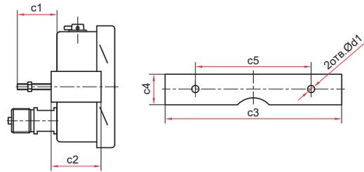
Эксцентрическое присоединение со скобой (Ø100, 150, 160 мм)
