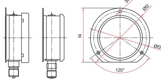
Радиальное присоединение с задним фланцем (Ø63 мм)
