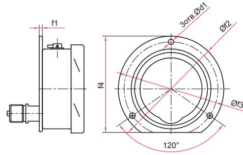
Эксцентрическое присоединение с задним фланцем (Ø100, 150, 160 мм)
