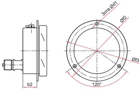
Эксцентрическое присоединение с передним фланцем (Ø100, 150, 160 мм)
