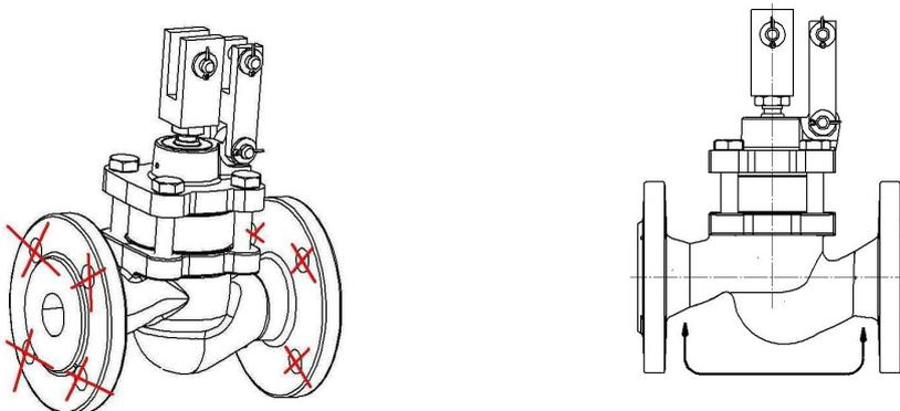
Место крепления для транспортировки клапана
