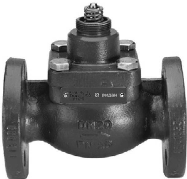
VFM-2R – клапан регулирующий, седельный, фланцевый, разгружен по давлению, предназначен для применения с адаптером 065Z0311R с электроприводами ARV(E)–1000R; без адаптера с электроприводами AMV (E) 10(13,13 SU); AMV (E) 23, 23SU, 33); ARV (E) 152, 153 в системах тепло- и холодоснабжения зданий, регулирования потока теплоносителя проходящего через него и получения необходимой температуры теплоносителя для потребителя.
